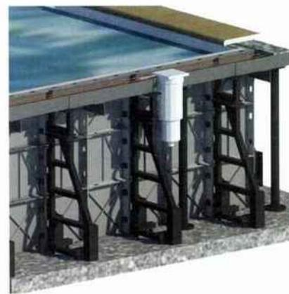
La structure de la piscine est en panneaux PVC en résine de synthèse, matériau écologique, hautement résistant et imputrescible. Des panneaux maniables et un assemblage panneaux/jambes de force très simple grâce aux clavettes de serrage. **Detente**
